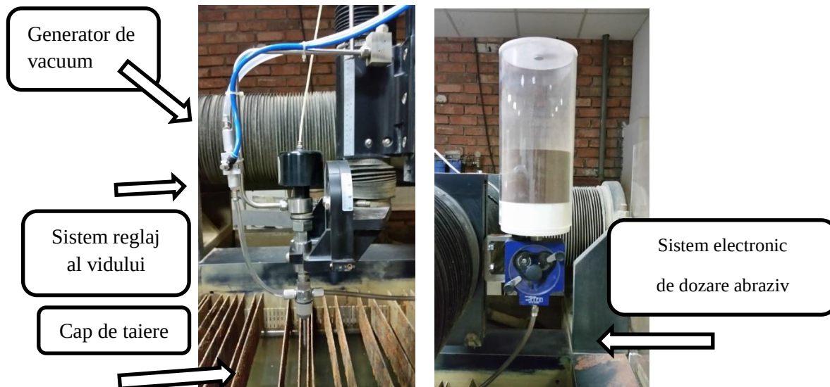
Fig. 2. Sistemul de alimentare cu abraziv dezvoltat pentru evitarea delaminarii
